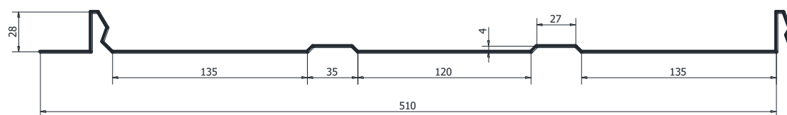
Rys. 17. Wymiary rąbka dachowego RD510 przyjęte do obliczeń
